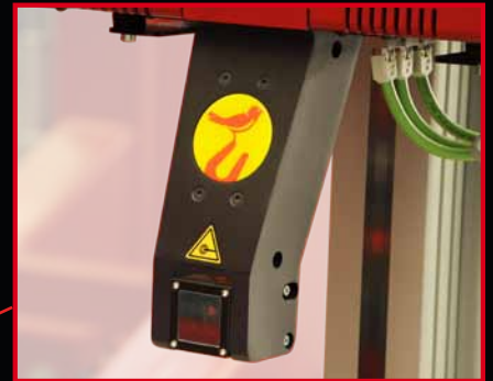
Distancemètre laser pour la recherche du pont élévateur et de la roue
