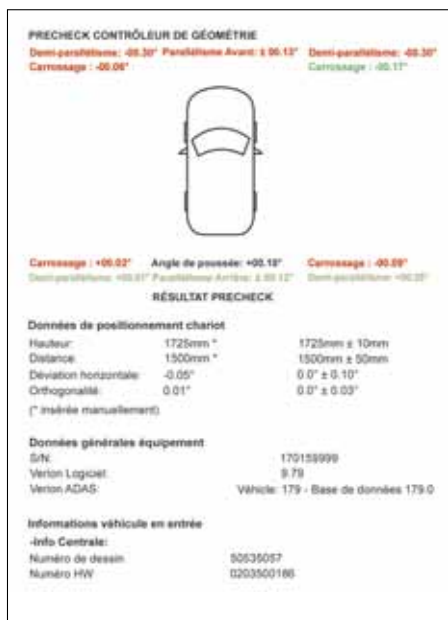
Exemple de Precheck Contrôle de géométrie Beispiel der Vorprüfung der Achsvermessung
