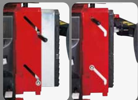
**3** Le groupe détalonneur a l'appui de la jante télescopique à deux positions (brevet CORGHI) pour détalonner tous les types de roues jusqu'à une largeur maximum de 14". **3** Die **Abdrückvorrichtung mit teleskopischer Zweistufen-Radauflage (Corghi-Patent)** kann alle Reifentypen bis zu einer maximalen Breite von 14" abdrücken.
