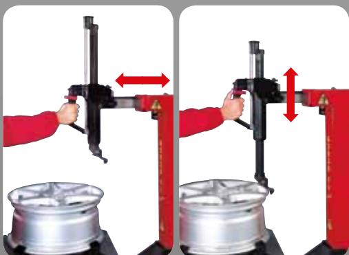
**2** Blocage pneumatique simultané du bras horizontal et de celui vertical porte-tourelle avec positionnement automatique de cette dernière dans la position idéale de travail. **2** **Gleichzeitige pneumatische Arretierung** von Horizontal und Vertikalarm mit automatischer Positionierung des Montagekopfs in der optimalen Arbeitsstellung.
